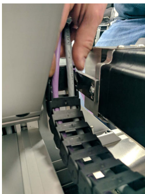
Principe de fonctionnement du système igus® QuickSnap
