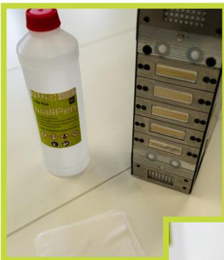
Für das Reinigen der Düse brauchst du das Flushing und 3 Dust Free Wipes. Feuchte zwei Dust Free Wipes mit dem Flushing an und wische vorsichtig und ohne Druck in eine Richtung über die Düse. Danach kannst du mit einem trockenen Dust Free Wipe vorsichtig in eine Richtung trocken wischen.
